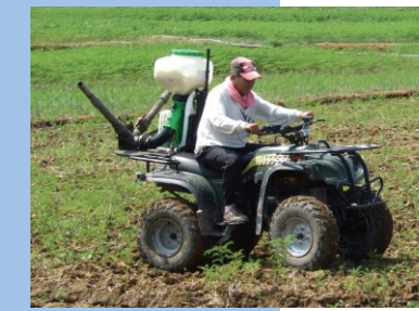
沙灘車搭載動力餌劑撒佈機
